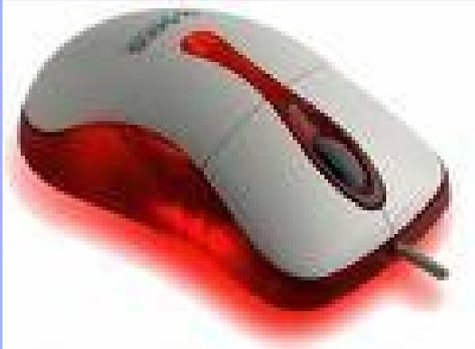
Mouse optis terdiri atas dua buah LED (*Light Emitting Diode*) dan dua buah lensa (*photo-transistor*) untuk mendeteksi gerakan.
